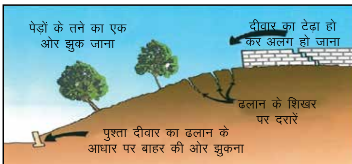
आकृति 5.7: चेतावनी संकेत (स्रोत: http://gabion1.com/retaining_wall_site_profile.htm )
